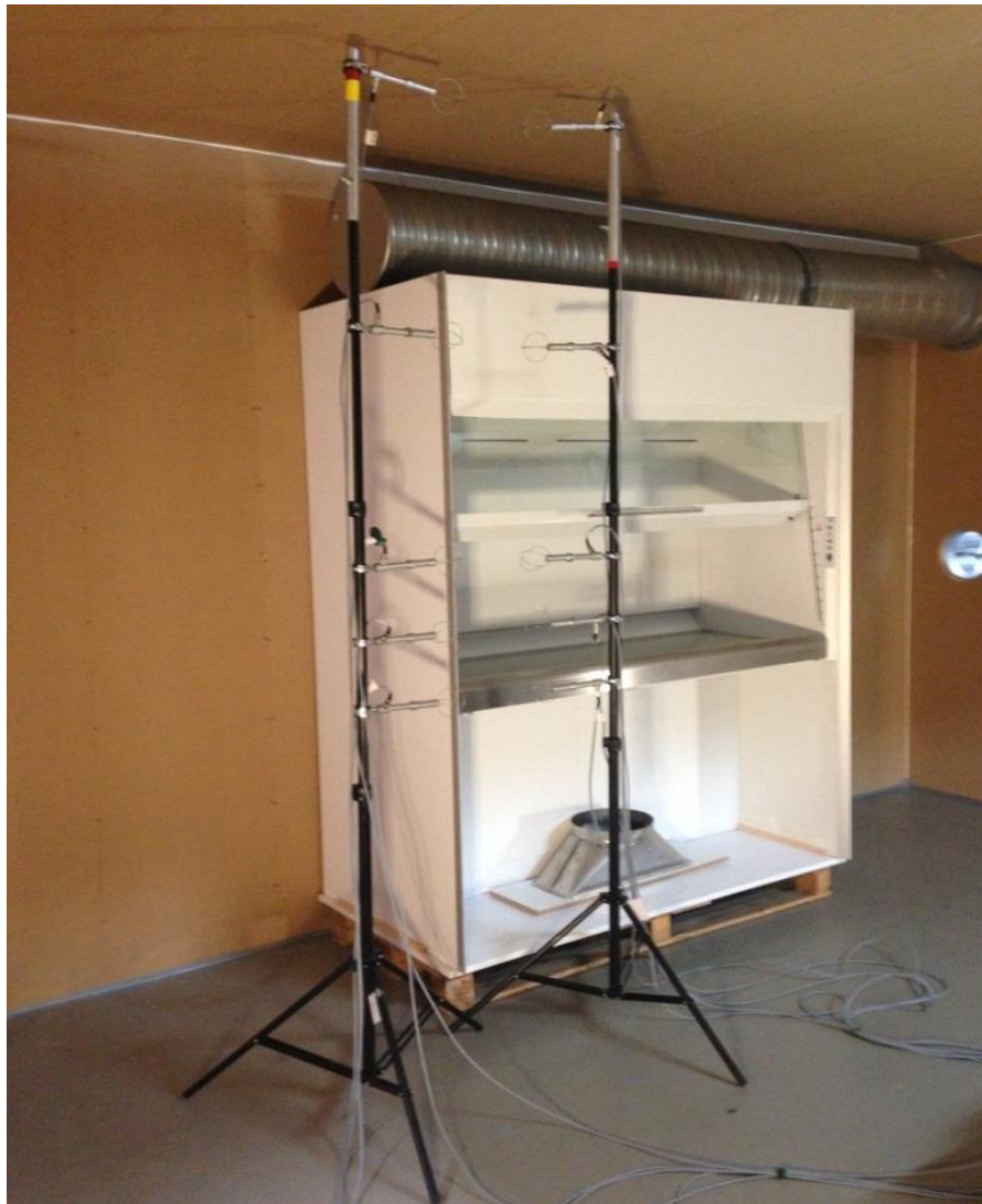
Figur 13 – Måleopstilling til referencemåling #1-4 med fem prober på hvert stativ; tre ude for åbningen, én lige under loftet, og én midt imellem den øverste og den ved toppen af lugens åbning.
