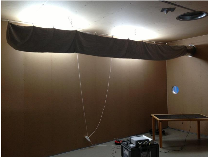
Figur 17 – Indblæsningspose. Overstrømshullet i væggen kan igen ses i baggrunden. I loftet ved siden af gennemføringen kan loft-termometret ses. Gulvtermometret er ikke synligt, men er monteret direkte under og på samme vis, bare i gulvhøjde.
