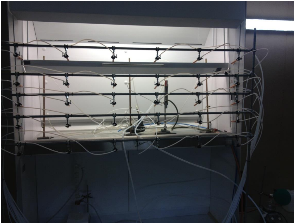
Figur 26 – Måleopstilling iht. EN/DS 14175-3. Måling med isobuten.
