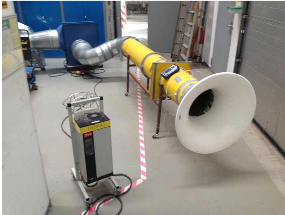
Figur 15 – Venturi dyse Ø315 med trykmåler forbundet til ekstern ventilator med frekvensomformer.
