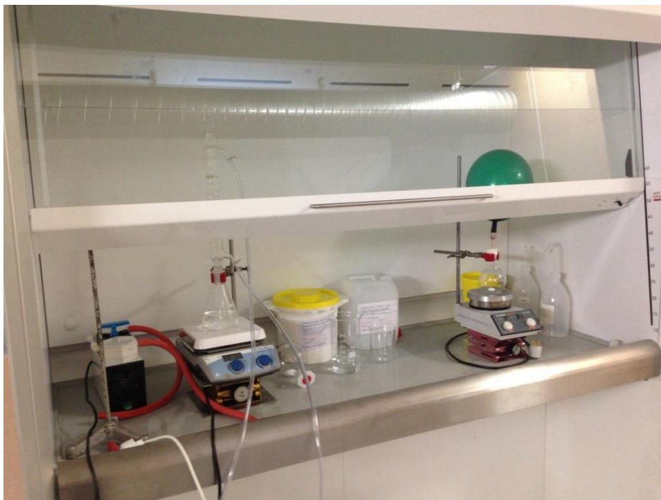
Figur 21 - Opstilling af udstyr i stinkskabet (før gastilførselsudstyret er sat op). Magnetomrøreren til venstre er som det eneste stykke udstyr i skabet tændt og opvarmet til 250° under forsøget.
